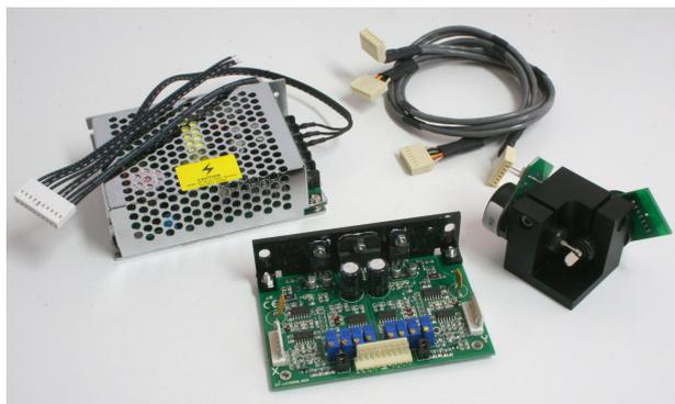
Ein Doppelnetzteil (siehe Bild) kann außerhalb der EU oder auf besonderen Wunsch mitgeliefert werden, da hierüber seitens des Herstellers keine CE-Konformitätserklärung vorliegt.
